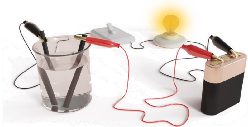
Fig.1 Montagem experimental para verificação da existência de carga elétrica.
